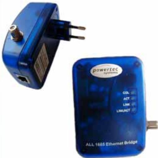
Mit dem Koaxlinemodem können Daten über das vorhandene Koaxialnetz wie in einem Netzwerk übertragen werden. Sollten Verstärker im Signalpfad vorhanden sein, welche nicht Rückkanalfähig sind, so können diese mit einem Bypass, bestehend aus dem Auskoppelfilter eLAN 1013 und dem Einkoppelfilter eLAN 1015, umgangen werden.
